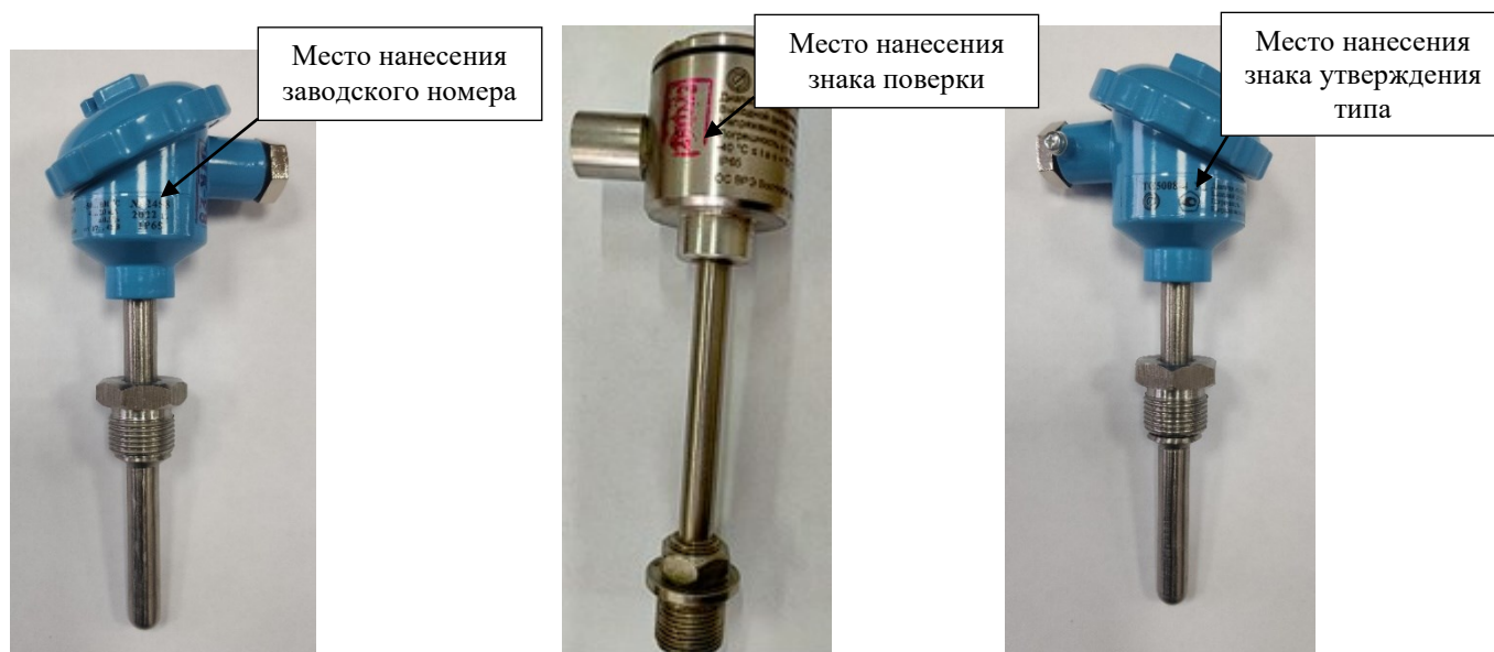
Рисунок 2 – Общий вид датчиков температуры ТС5008 с указанием мест нанесения знака поверки, знака утверждения типа и заводского номера
